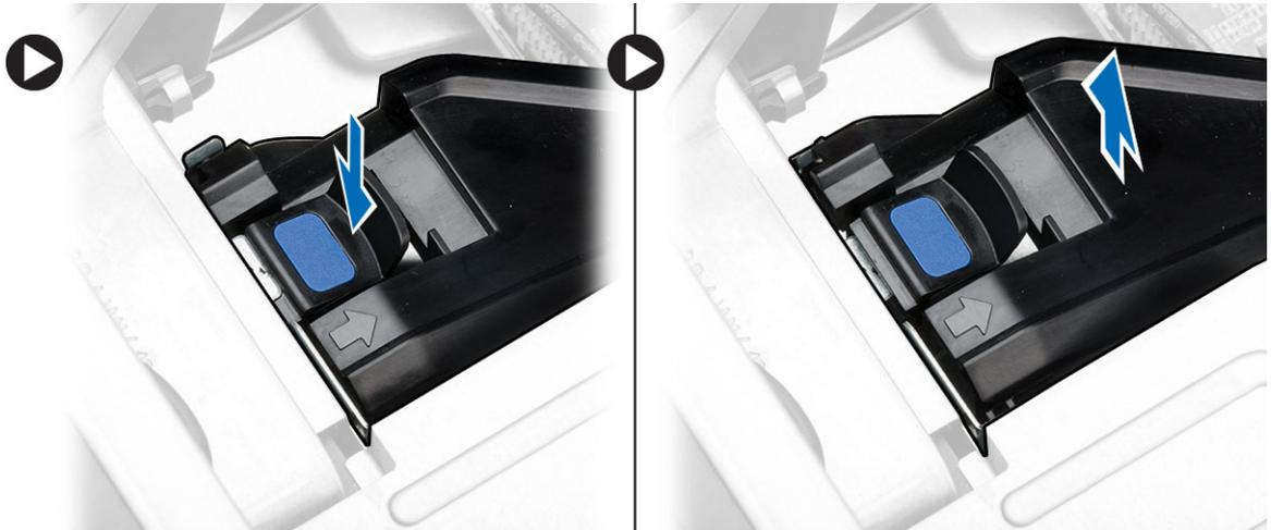
4. Repita el **Paso 3** para quitar el módulo del segundo túnel de aire del equipo.
