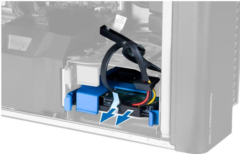
4. Presione los pestillos al lado del soporte de la unidad de disco duro.
