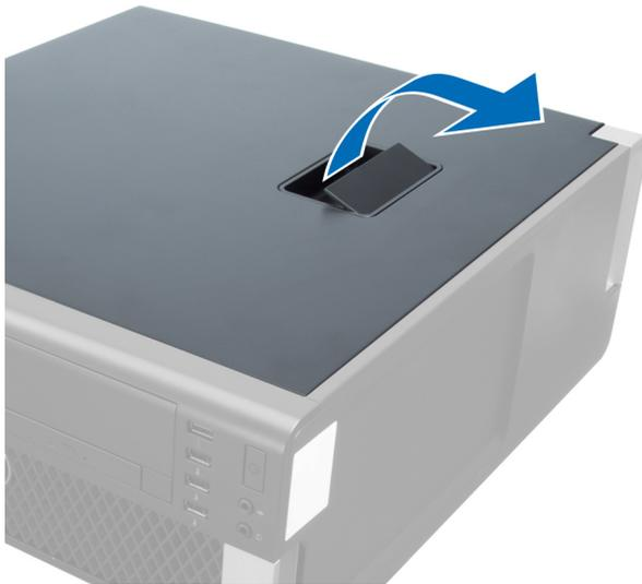
4. Levante la cubierta hacia arriba con un ángulo de 45 grados y retírela del equipo.
